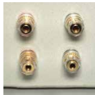
ダブルボイスコイル仕様のドライバー
