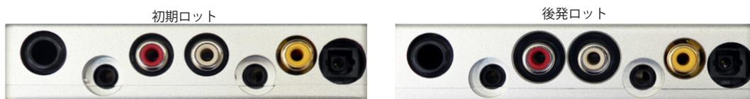
RCA アナログ出力端子開口部（赤・白）の直径が約 11mm から 13mm へ拡大
